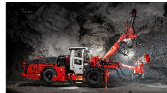
Fotografía 5. Jumbo DD422iE de dos brazos a batería. Fuente Sandvik
