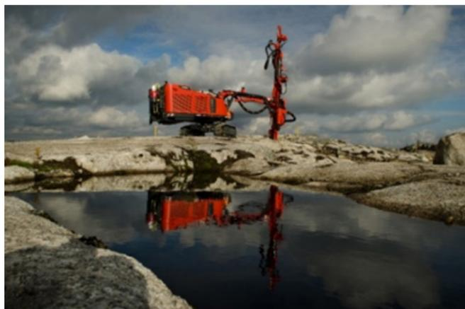
Fotografía 3. Ranger DX800 equipo de perforación con martillo autónomo en cabeza. Fuente Sandvik
