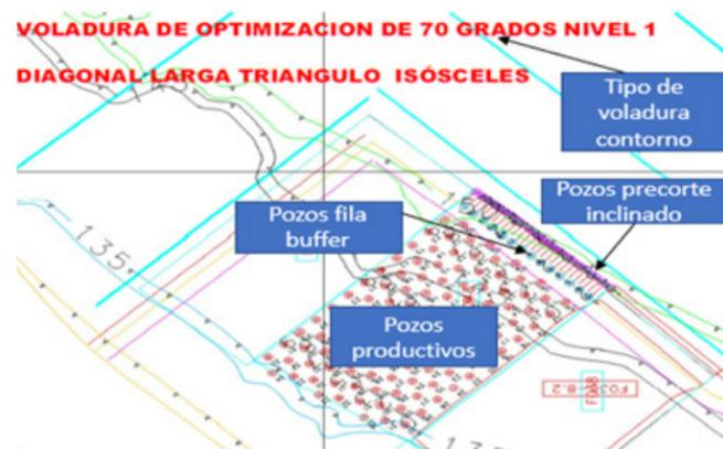
Figura 4. Plantilla diseño perforación de una voladura.
