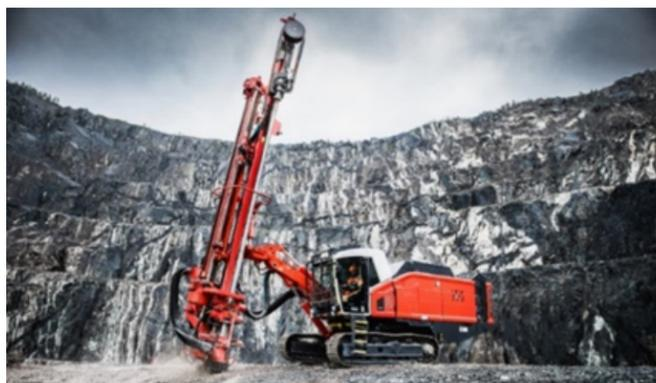
Fotografía 4. Leopard™DI650i equipo de perforación con martillo de fondo. Fuente Sandvik
