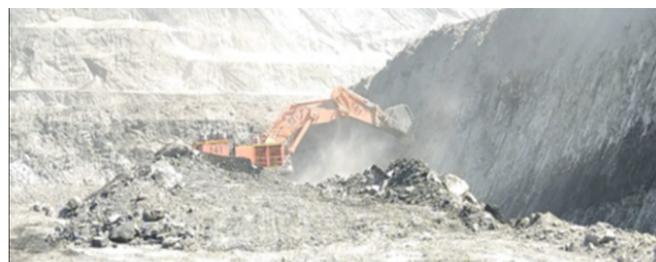
Figura 9. Retroexcavadora perfilando talud.
