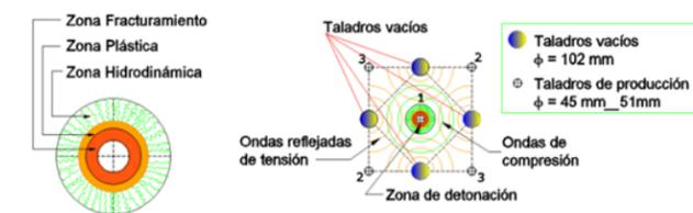
Figura 14. Zona de energía y expansión en la detonación de un barreno.
