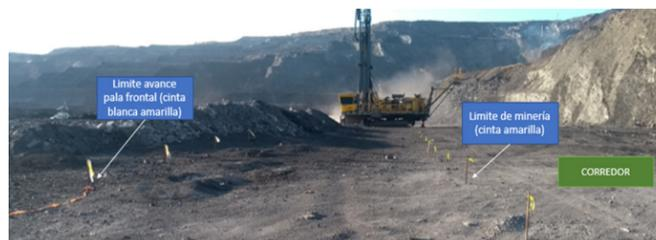
Figura 8. Demarcación de límite de minería y límite de avance con pala frontal.
