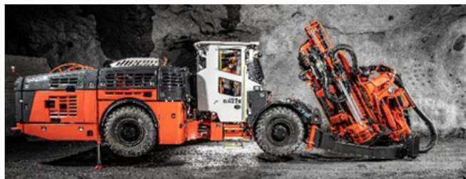
Fotografía 7. Jumbo DL422iE a batería y de operación remota para barrenos largos. Fuente Sandvik
