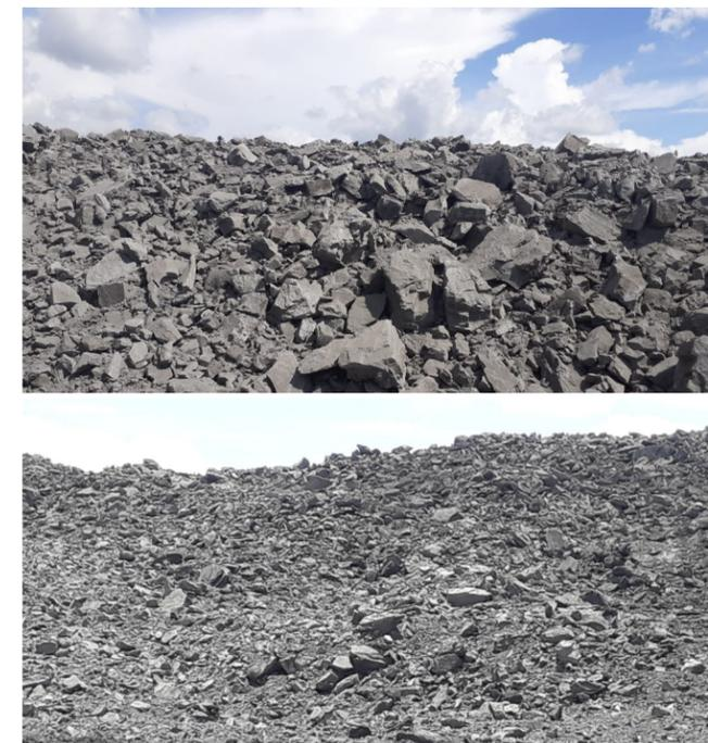
Figura 4. Voladura convencional (Superior) / Voladura con cámaras de aire (Inferior).
